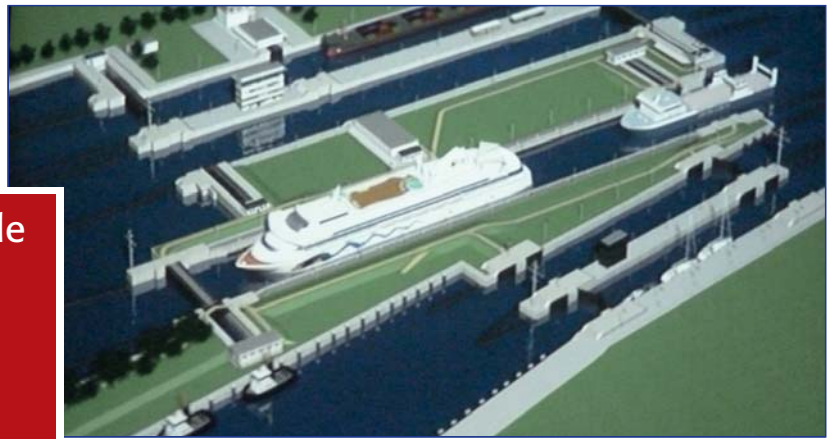
Mit dem Bau der 5. Kammerschleuse wird die Kapazität der Kanal-Schleusen in Brunsbüttel wesentlich erweitert.
