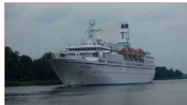
Die „Astor“ hat eine Länge von 176 m und ist mit 20.704 BRZ registriert. 578 Passagiere können an Bord kommen. Das Schiff fährt unter der Flagge der Bahamas.
