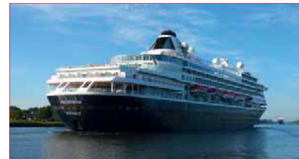
Die „Prinsendam“ fährt unter der Flagge der Niederlande und hat eine Vermessung von 31.051 BRZ. Das Schiff ist 206 m lang und für 793 Passagiere zugelassen.
